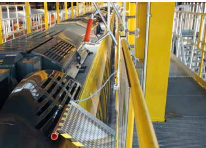
Die Ausschübe sind mit Kantenschutzprofilen ausgestattet, damit mit Spaltmaß Null gearbeitet werden kann und gleichzeitig die Außenhaut des Zuges nicht beschädigt wird.
