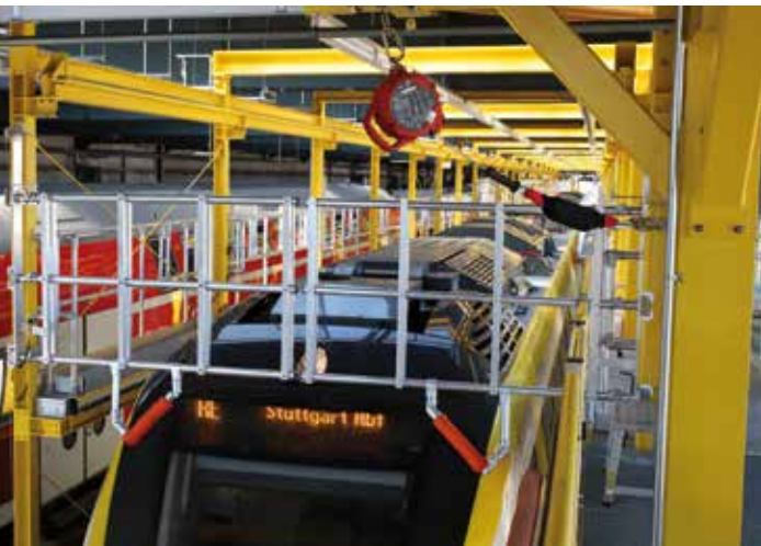
An der Zugfront bietet ein schwenkbares Geländer Sicherheit.
