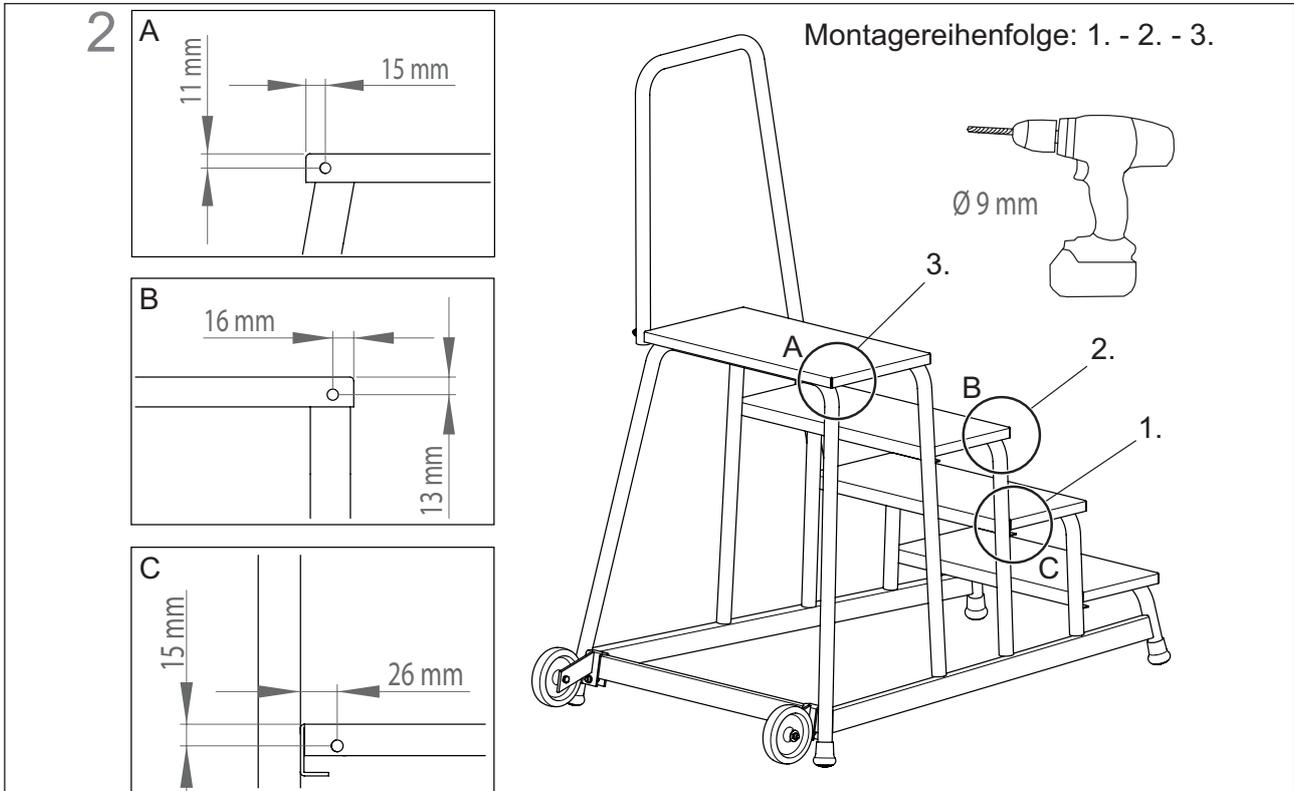
Handlauf links spiegelgleich wie Handlauf rechts montieren.
