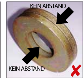
TELLERFEDERN NICHT SO MONTIEREN
