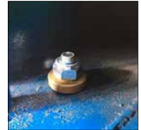
TELLERFEDERN NICHT SO MONTIEREN
