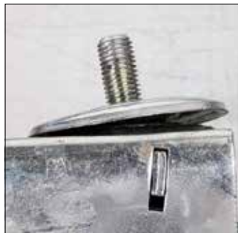
Verformung der Befestigungsplatte aufgrund eines einzigen heftigen Aufpralls oder mehrerer weniger heftiger Aufpralle. Selbst wenn sich die Laufrolle ansonsten in gutem Zustand befindet, muss sie ersetzt werden.
