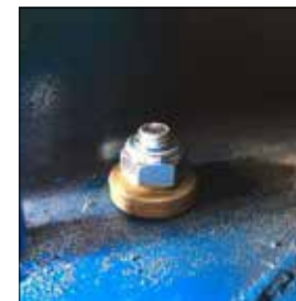
TELLERFEDERN NICHT SO MONTIEREN
