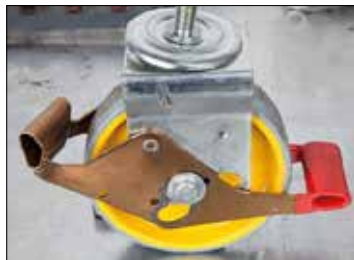
Verformung des Fußpedals aufgrund eines heftigen Aufpralls. Vermutlich sind die obere Befestigungsplatte und das Rollenlager auch verformt.
