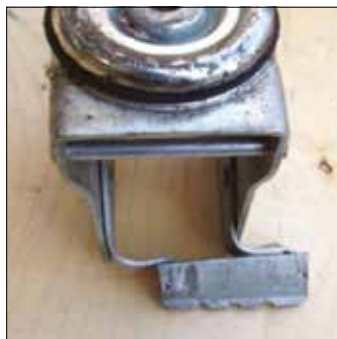
Verformung des Fußpedals aufgrund eines heftigen Frontaufpralls. Vermutlich sind die obere Befestigungsplatte und das Rollenlager auch verformt.
