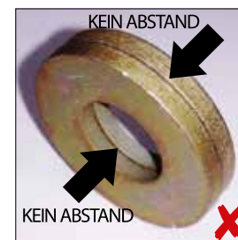
TELLERFEDERN NICHT SO MONTIEREN
