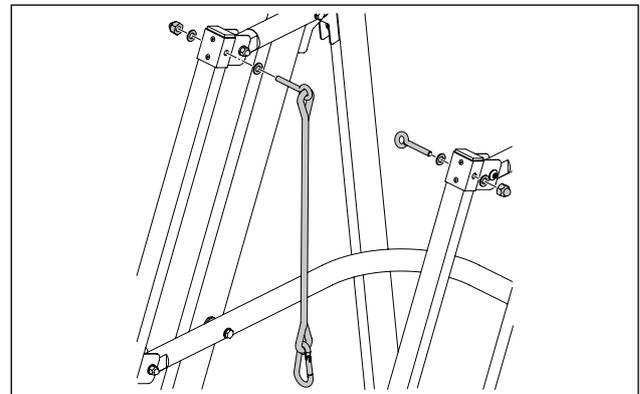
Bei der Montage darauf achten, dass beide Flügel der Sicherungstüre auf der gleichen Höhe montiert werden.
