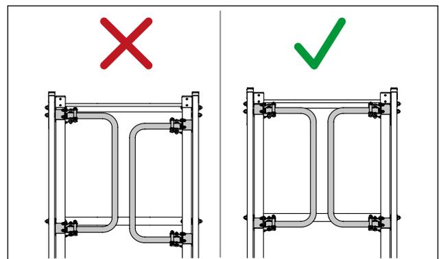
Der Abstand zwischen Geländerbefestigung der Plattformleiter und der Sicherungstüre darf maximal 10 mm betragen.
